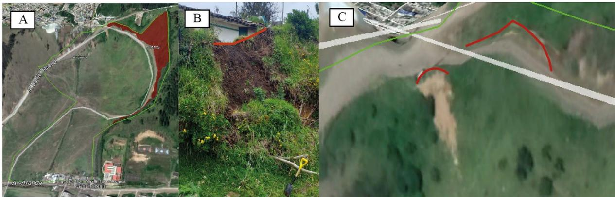
**Figura 8. A:** Ubicación de ladera convexa en la imagen satelital **B:** Fotografía de la corona del deslizamiento ubicado en la vía terciaria que comunica a Tescual **C:** límite de la corona del escarpe (rojo)
